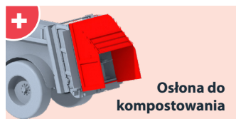
Kłapa składana, by ograniczyć wysokość.
